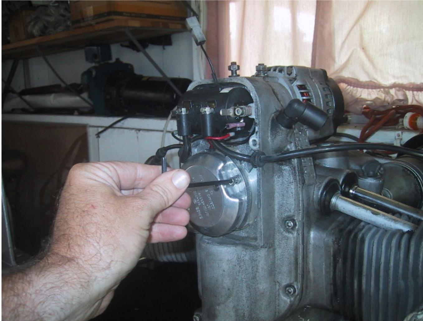
**Retirer les 2 vis de fixation. Les vis OEM sont fendues. J'utilise une clé Allen de 4 mm pour retirer mes vis mécaniques du marché secondaire. Placez les vis dans le couvercle de distribution pour éviter de les perdre.**
