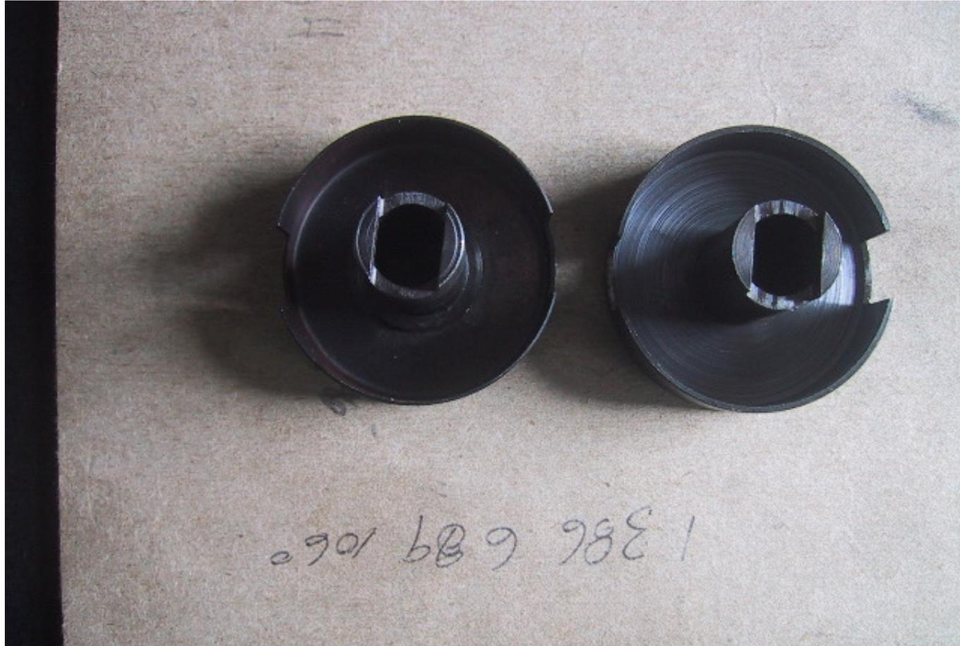
**À gauche, on peut voir un interrupteur à joint serti en deux parties fabriqué au début. À droite, on voit un rupteur plus récent, usiné en une seule pièce. Les deux sont faciles à distinguer, car le deux-pièces présente un épaulement à la jonction avec la jupe ronde...**
