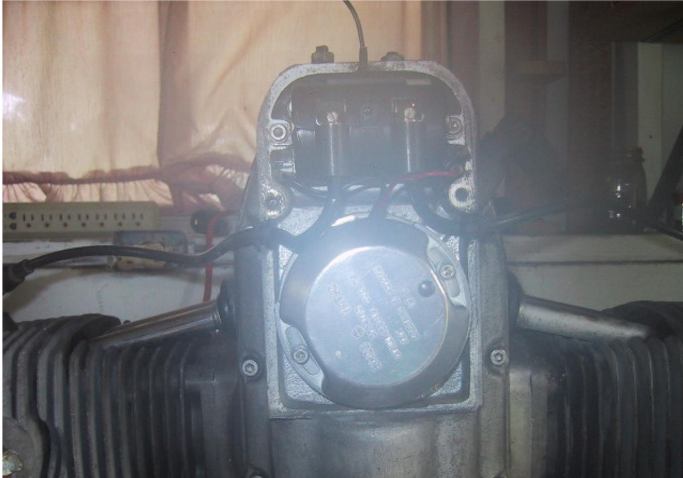
**Retirez le couvercle de distribution et placez les vis à l'intérieur du couvercle pour éviter de les perdre.
