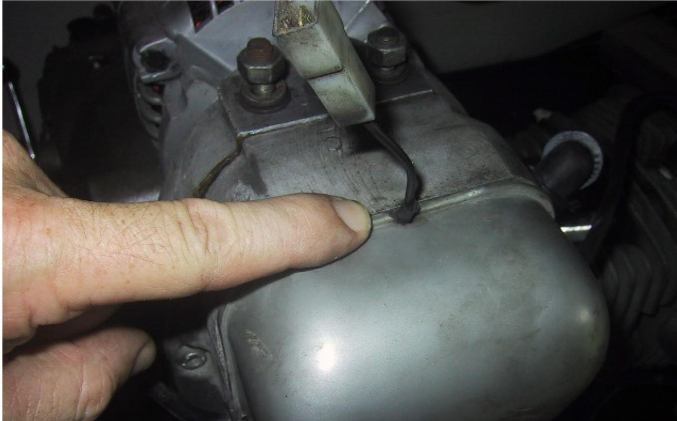
**Habituellement, les Russes marquent la plaque d'une ligne de lubrification, comme indiqué à côté du pointeur. Si le vôtre n'en a pas, le trou rond de la plaque doit être centré à côté de la quatrième marque de hachage sur la plaque de base. Une fois que vous avez réglé la synchronisation, faites votre propre marque de référence. Vous pouvez l'utiliser pour régler la synchronisation sans avoir à suivre toute la procédure décrite dans la section "A".**
